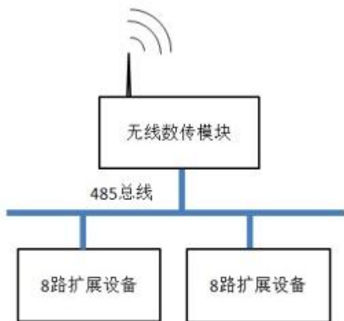
图 5-5 本产品独立使用连接图
